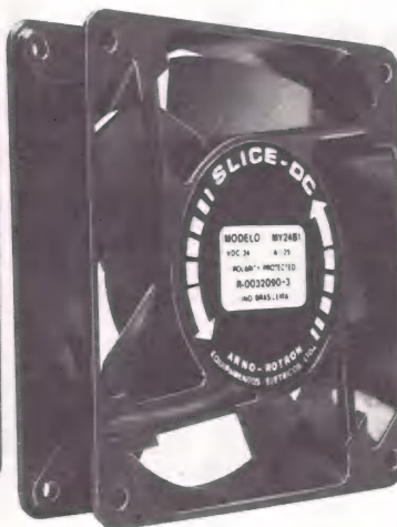
Slice DC. Espessura de apenas 25 mm, ideal para aplicações em áreas estreitas. Fluxo de 24 a 38 l/s.
